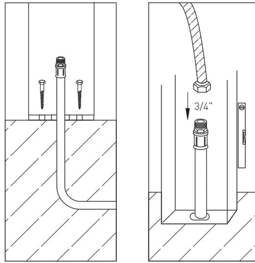
Verschrauben Sie die Brunnenstele mittels der mitgelieferten Schrauben sicher auf dem vorbereiteten Untergrund.
