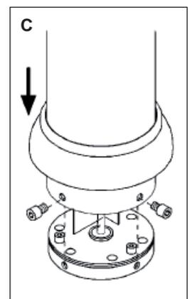
Die Leuchten sind bis zum Sockel verkabelt und geerdet, Schutzart IP 54 - Der Fußpunkt der Leuchte darf nicht überflutet werden.
