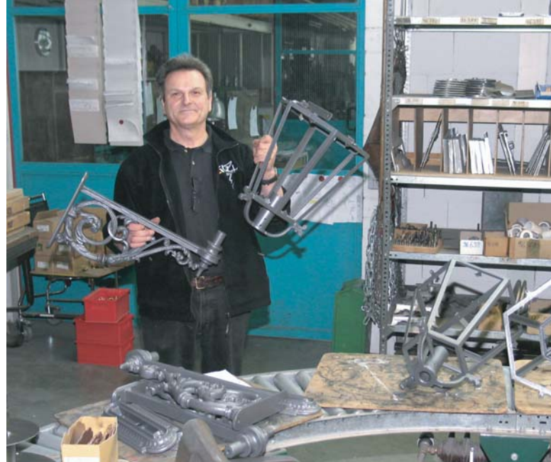
VIELE UNTERSCHIEDLICHE BAUTEILE aus der Kull'schen Schmiede fügen sich am Ende zu einer ganzen Leuchte zusammen. Foto: kle
